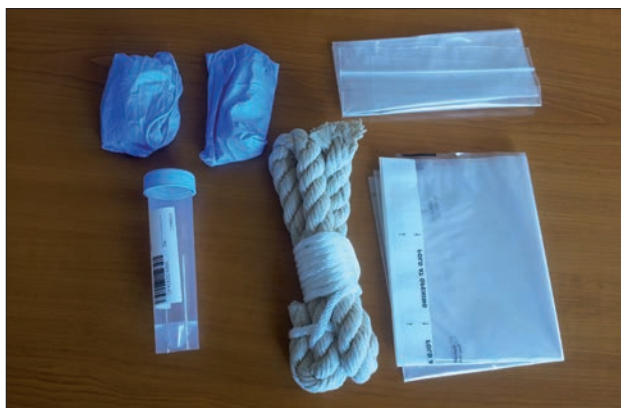
Obr. 1 – Souprava pro odběr vzorku slin prasat – bavlněné lano, zkumavka, igelitové sáčky a rukavice
